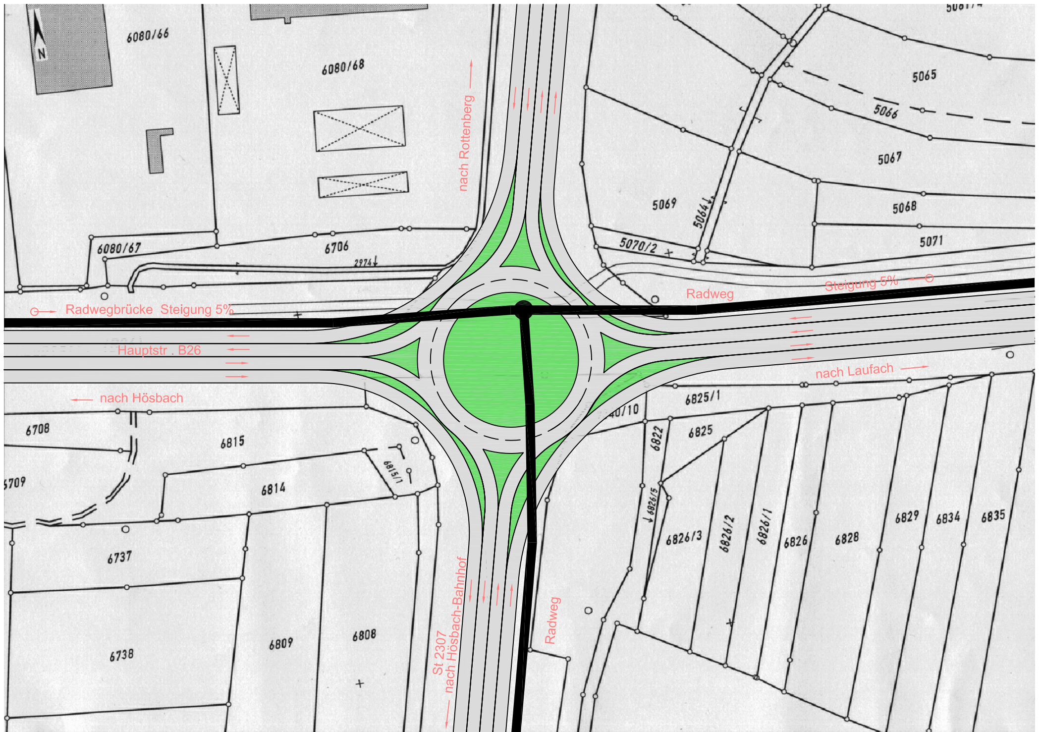
Vorschlag Kreisellösung B26/St 2307, 2-spurig mit Bypass und Radwegüberquerung, M1:1000, VIH 9.3.2007
